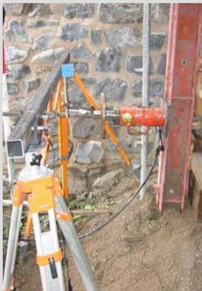
Druck + Messvorrichtung des Auszugsversuches
